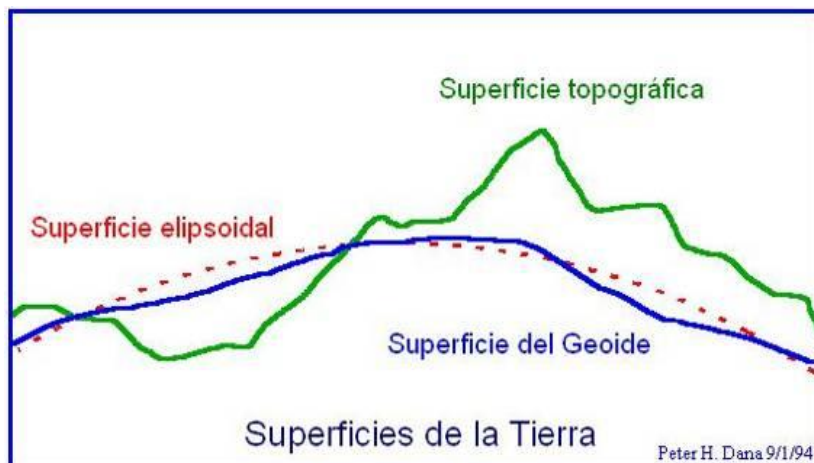
Figura N° 6. Superficie de la Tierra, geoide, y elipsoide. Tomado de Dana, 1994.
