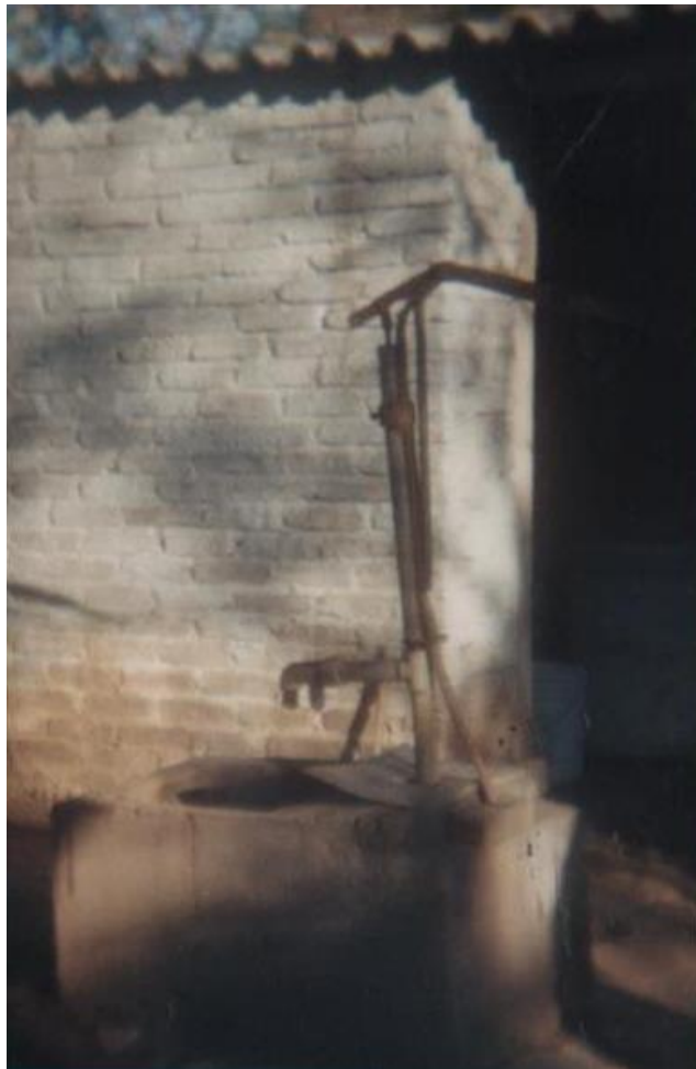
Bomba de agua. Con todos sus elementos originales. En el extremo libre de la palanca bombeadora se observa un caño de escopeta, por rotura de la misma, colocada por Ángel.
